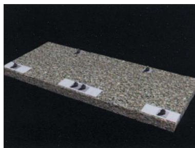
2 らくピタ(敷高調整治具)設置 製品1本につき、3個使用
