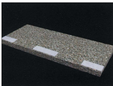
1 基礎材敷均し、荷重分散板設置
