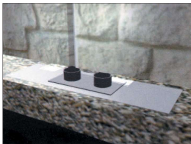
4 ツメ付きジャッキによる高さ調整
