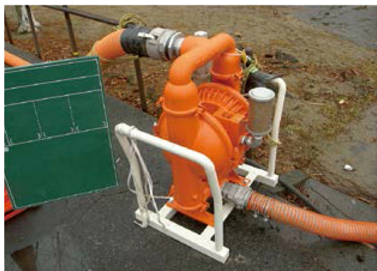
エアハートポンプ外観
